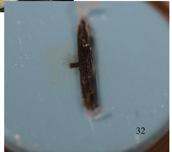
上図 貼り合わせたPETフィルム ⊥と∥ 方向を測定できる
